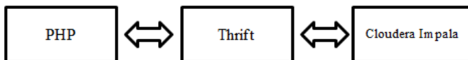
ภาพที่ 3-22 บล็อกไดอะแกรม PHP ติดต่อกับ Cloudera Impala
