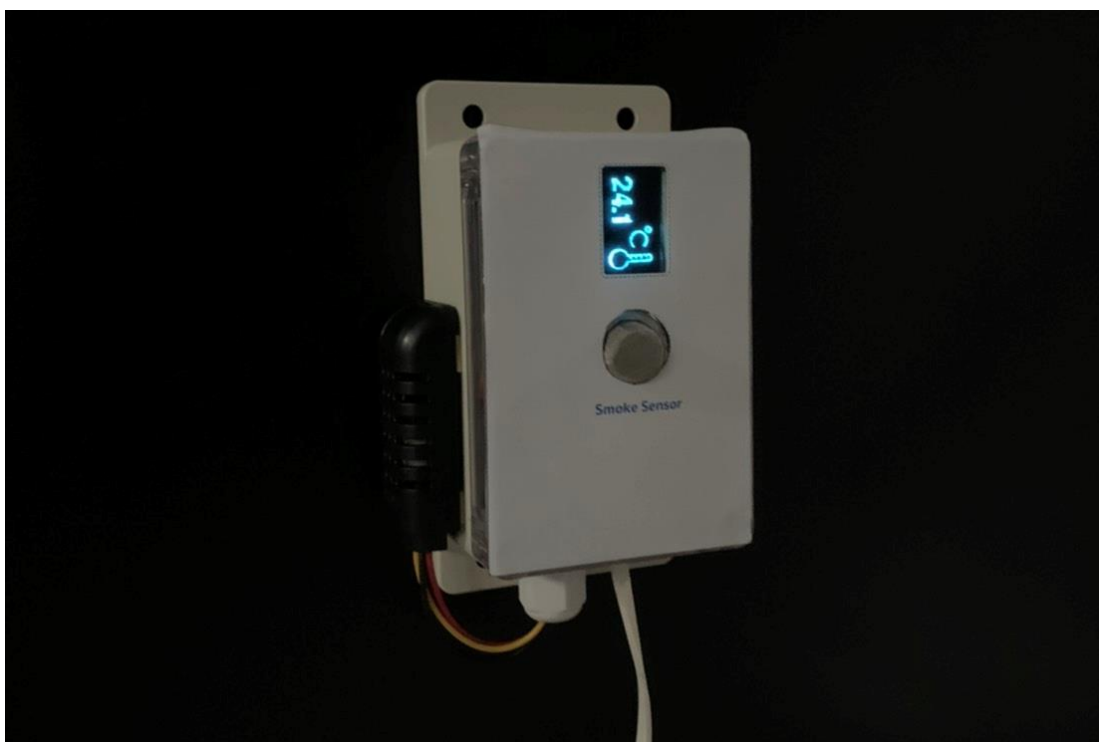
ภาพที่ 4-1 อุปกรณ์ที่ติดตั้งสำหรับวัดค่าอุณหภูมิ ความชื้น และควันไฟ
